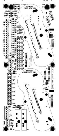
Figure 98: Pulse Input Module redundant IOTA
