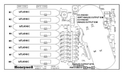
Figure 253: CC-GAOX21 Analog Output IOTA
